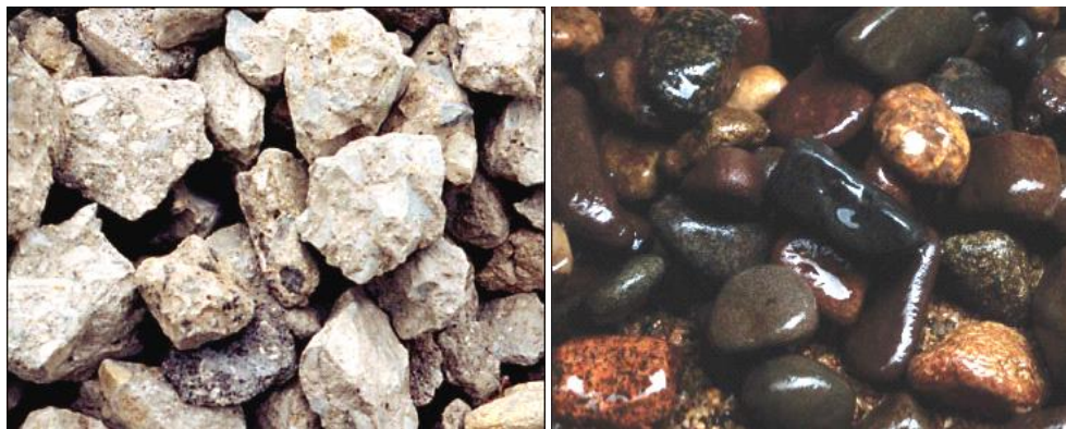
Figure 2.1: La forme des granulats.
