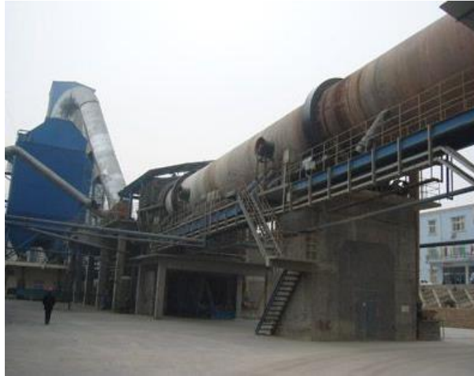
Figure 3.4: Four rotatif pour la fabriquer de la chaux.
