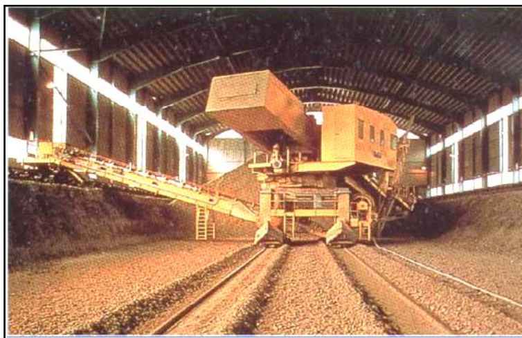
Figure 3.7 : Méthode de préparation du cru.
