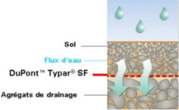
Figure 08 : Fonctionnement de filtre géotextiles
