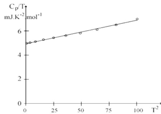
**Fig.** Valeurs expérimentales de la capacité calorifique du Fer reportée dans un diagramme  $C/T$  en fonction de  $T^2$ .
