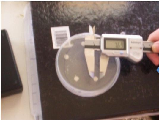
**Lecture des résultats: Mesure des diamètres des zones d'inhibition**
