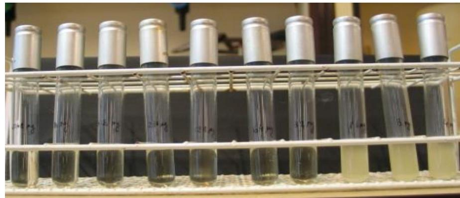
**Détermination de la CMI en milieu liquide en tube**
