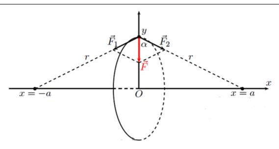
A cause de la symétrie, on a  $F_1 = F_2 = K \frac{qQ}{r^2}$ , La force résultante exercée sur Q est parallèle à y'Oy. Par conséquent,  $F=2K\frac{qQ}{r^2}\cos\alpha$ , où  $r^2=y^2+a^2$  et  $\cos\alpha=\frac{y}{r}=\frac{y}{(y^2+a^2)^{1/2}}$ Donc,  $F = 2K \frac{qQy}{(y^2+a^2)^{3/2}}$ , Si l'on place Q sur n'importe quel autre point du cercle perpendiculaire à x'Ox, de centre O et de rayon R = y, on aura une force de même module est dirigée vers O.
