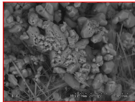
d'ettringite à la surface de la fissure (grandissement 1000×)
