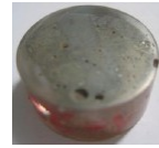
Mise sous vide des échantillons à surfaces polies
