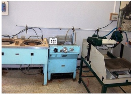
Préparation des échantillons (découpage et polissage)
