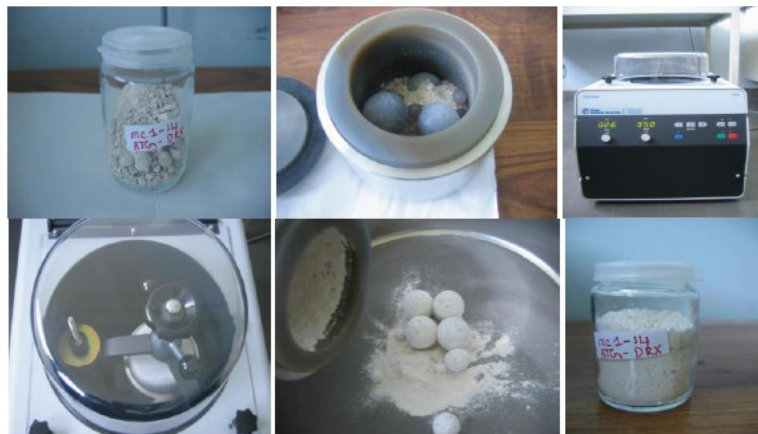
Préparation des échantillons pour l'ATG et la DRX
