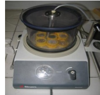
Mise sous vide des échantillons à surfaces polies
