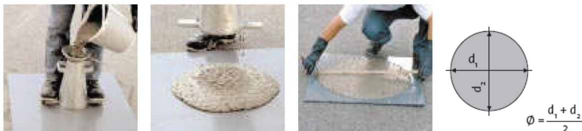
Différentes étapes de l'essai d'étalement
