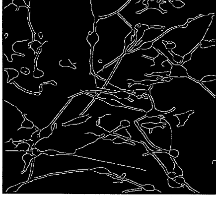
Figure IV.22 : Deriche ( \alpha = 1 ) sur l'image originale suivi d'un seuillage par hystérésis ( S_h = 25 , S_b = 5 )
