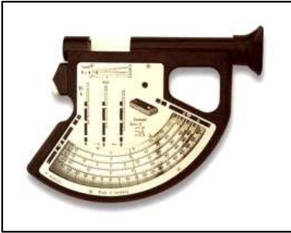
Photo 7 : le dendromètre BLUME-LEISS
