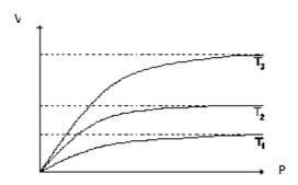
Plusieurs isothermes d'un même couple adsorbant-adsorbé. On a  $T_1 > T_2 > T_3$
