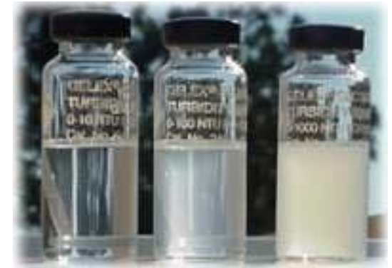
Etalons de turbidité de 5, 50 et 500 NTU
