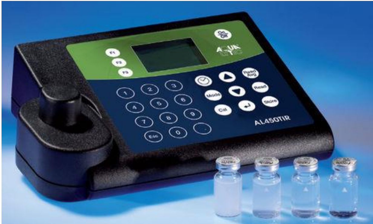
Etalons de turbidité de 5, 50 et 500 NTU
