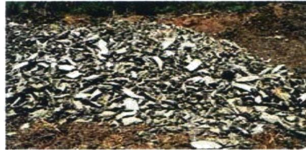
**Fig. 112** - Boues solides issues de filtre-presse
