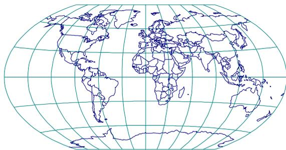
Figure 9.12. Projection triple de Winkel
