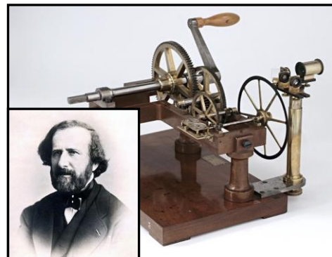
Hippolyte Fizeau (1819-1896) et son mécanisme à roue dentée avec les lunettes d'observation (1849).
