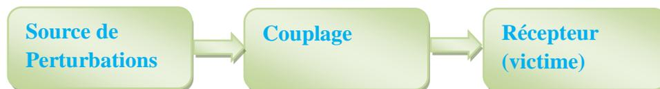
Figure 1.5: Synoptique d'un problème CEM.
