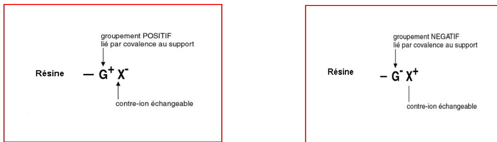
Figure III.9. Résines anionique et cationique
