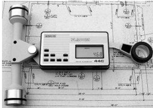
الشكل 7 أ: جهاز بلانميتر رقمي من نوع بلاكوم Placom يستخدم لحساب المساحات.
