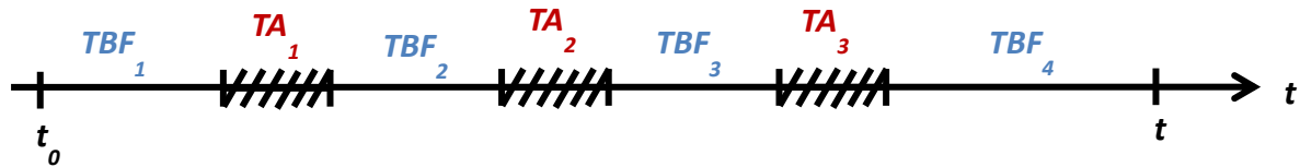
Figure III.1. Vie d'un équipement.
