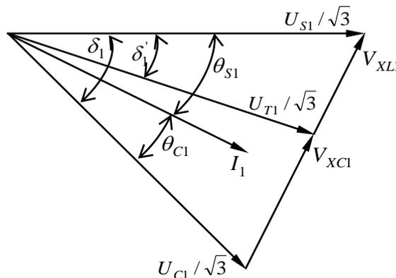
Fig. 2.7: Rectifier Side Vector Diagram
