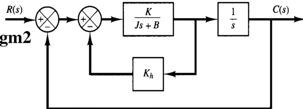
Calculer les gains  $K$  et  $K_h$ , pour avoir : un dépassement  $M_p=.2$  et un temps de pic  $t_p=1$ .
