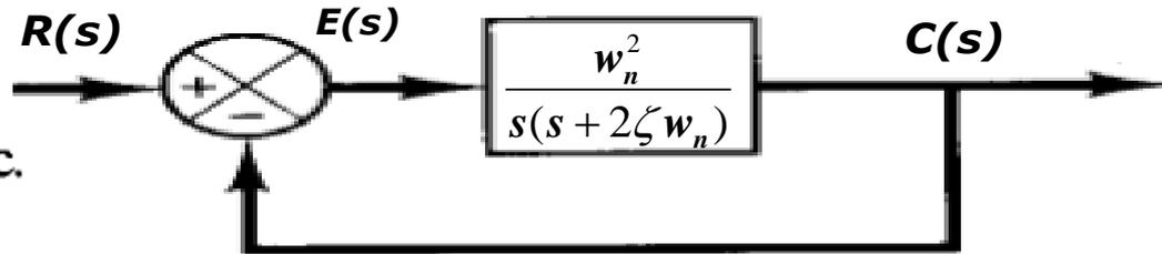
1- le temp de montée 2- le temps de pic, 3- le dépassement maximale, 4- le temps de stabilisation.
