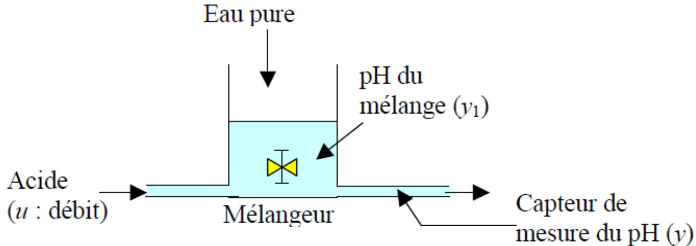
Le pH mesuré  $y$ , représente le pH  $y_1$  réalisé plus tôt :  $y(t) = y_1(t - T_r)$
