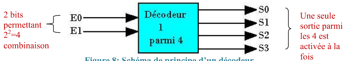
Figure 8: Schéma de principe d'un décodeur
