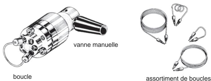
**Figure 2.4** Vanne d'injection pour CLHP et boucles assorties.
