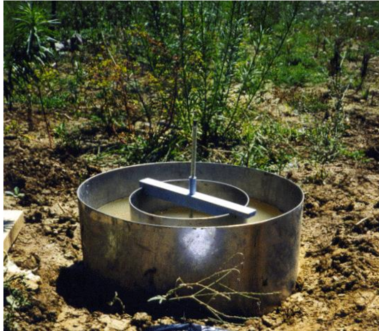
Fig. 2 – Mesure de l'infiltration d'un sol (Plaine de Asfour (Mai 2004))
