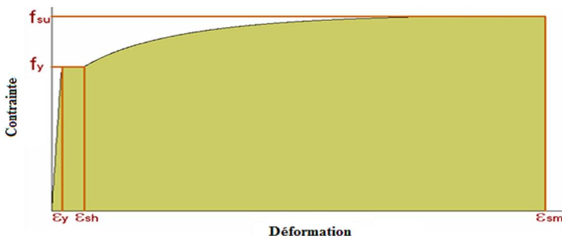
Fig. 3 Diagramme « contrainte – déformation » de l'acier
