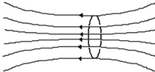
Figure 2.2: Exemples de tube de champ : ensemble de lignes de champ reposant sur un contour ferme
