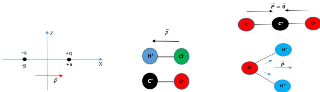
Figure 2.4: Exemples de dipôles électriques.
