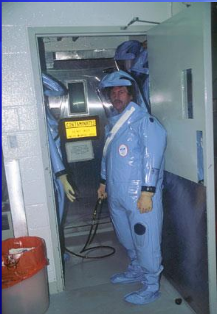
sas d'entrée pour étude sur le virus Ebola en laboratoire haute sécurité P4,
