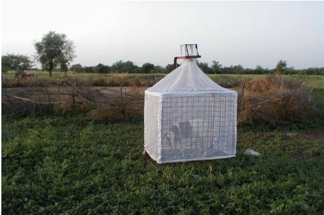
Cette cage est recouverte **d'une moustiquaire** qui laisse un passage de quelques centimètres au dessus du niveau du sol servant de porte d'entrée aux moustiques et autres insectes attirés par les odeurs de l'animal appât.
