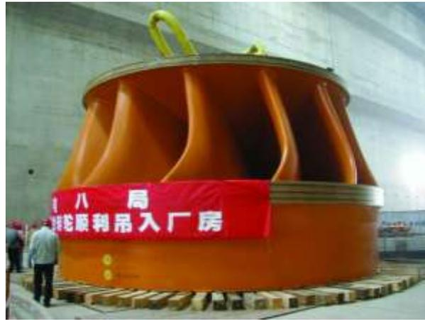
**Figure.** Turbine *FRANCIS* au barrage des Trois-Gorges, en Chine, construite par Voith.
