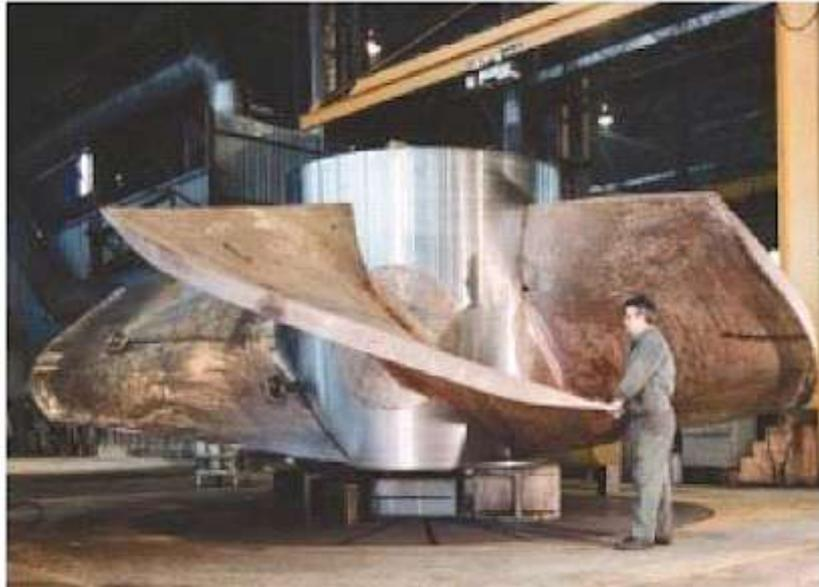
**Figure.** Montage d'une roue *KAPLAN* de grosse puissance. Usine de lachine, Québec, Canada..
