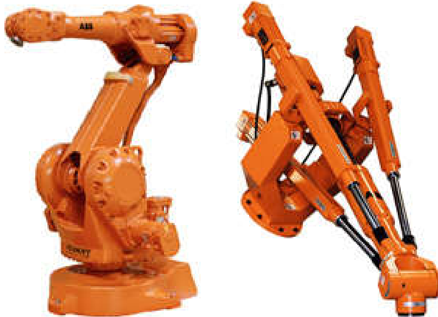
Figure 1-6 Exemples de robots à 6 degrés de liberté, à structures sérielle, respectivement parallèle (source : ABB – www-abb.ch )
