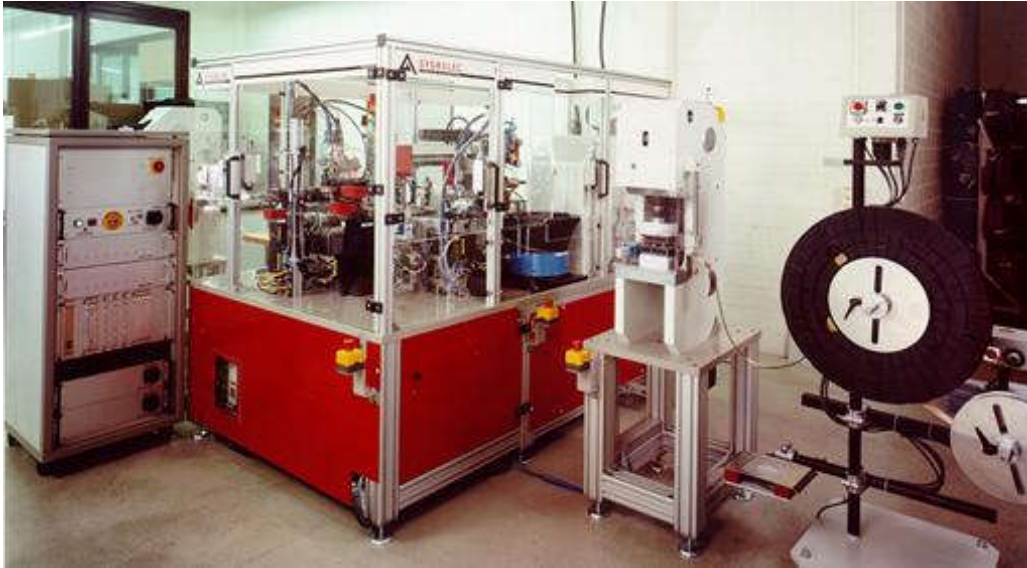
Figure 1-8 Machine d'assemblage avec actionneurs pneumatiques (Source : Sysmelec (CH) – www.sysmelec.ch )
