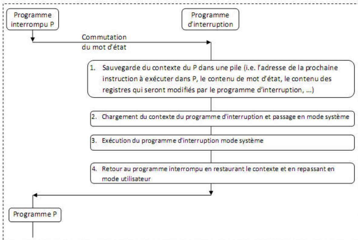
Une interruption a pour fonction de forcer un processeur à réagir à un évènement. L'exécution du programme en cours est suspendue et, un programme d'interruption est exécuté. Le programme interrompu repris ensuite son exécution.
