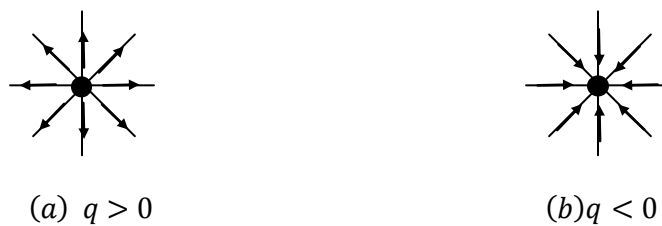
Fig(1.2) Sens de champ électrique (a) une charge positive (b) une charge négative
