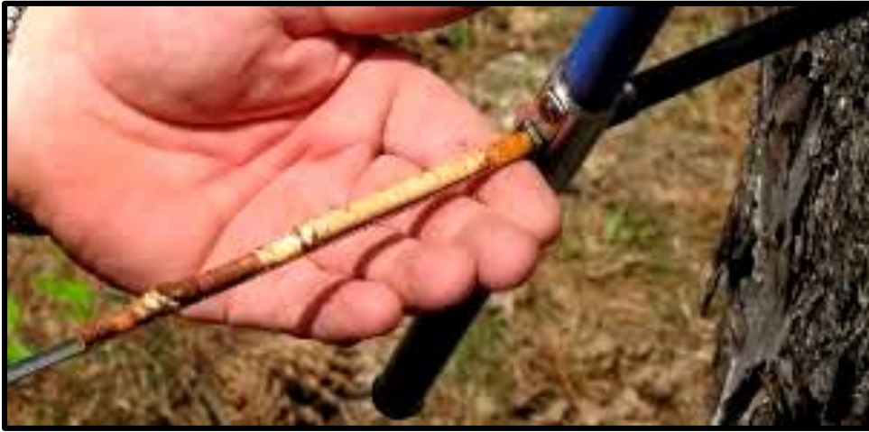
Extraction d'une carotte de sondage
