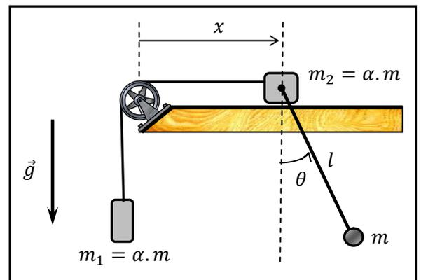
1. Trouver la vitesse  $\vec{v}_m$  de la masse  $m$  et son module  $v_m$  dans le référentiel lié au sol. (Dans le cas d'oscillations de petites amplitudes de la masse  $m$ , on prendra  $\cos \theta \approx 1$ ).
