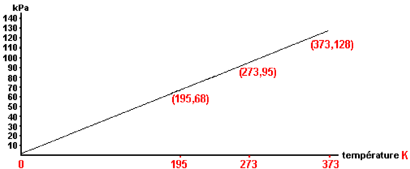
Pression en fonction de la température absolue
