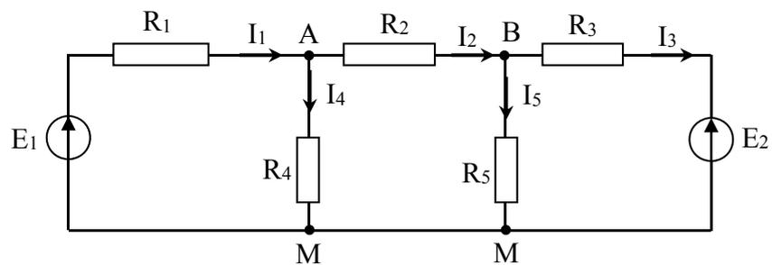
Déterminer les intensités  $I_1, I_2, I_3, I_4$  et  $I_5$  dans chaque branche du réseau.
