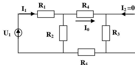
En utilisant le pont diviseur de courant, on obtient la valeur de  $I_0$  :
